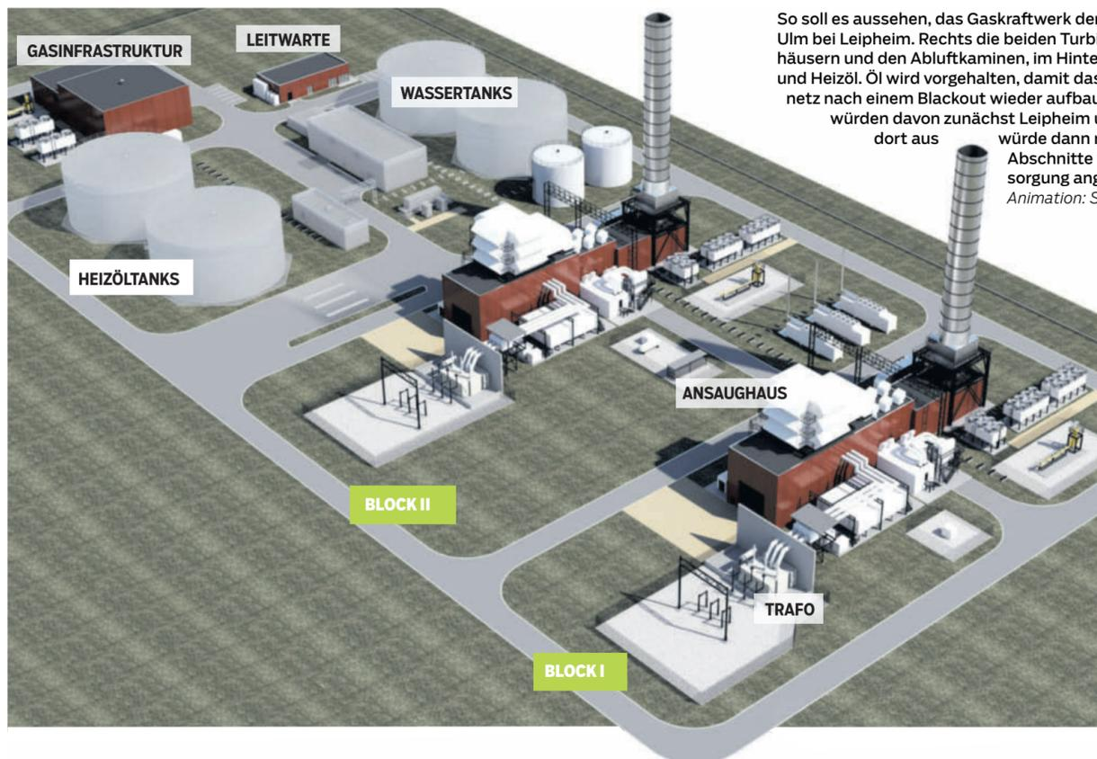
So soll es aussehen, das Gaskraftwerk der Stadtwerke Ulm/Neu-Ulm bei Leipheim. Rechts die beiden Turbinen mit den Ansaughäusern und den Abluftkaminen, im Hintergrund Tanks für Wasser und Heizöl. Öl wird vorgehalten, damit das Kraftwerk das Stromnetz nach einem Blackout wieder aufbauen kann. Profitieren würden davon zunächst Leipheim und Bubesheim, und von dort aus würde dann nach und nach weitere Abschnitte wieder an die Stromversorgung angeschlossen. Animation: Siemens
